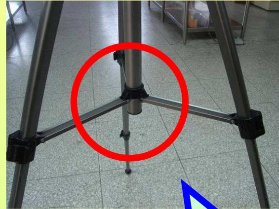
調整好長度後，將腳架打開，必須將中間的固定點調至底端，才能穩固。
